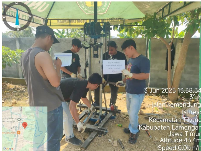
Gambar 7. Dokumentasi Uji Sondir Titik 3
