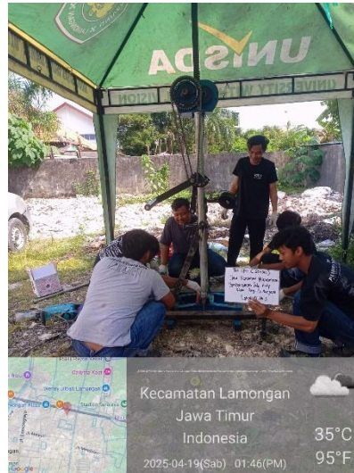
Gambar 5. Dokumentasi Uji Sondir Titik 2
